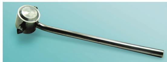
柔らかい新設アスファルト等へ打ち込む際に、ピンの頭部にかぶせた上から叩く事で標示部の破損を防止します。
